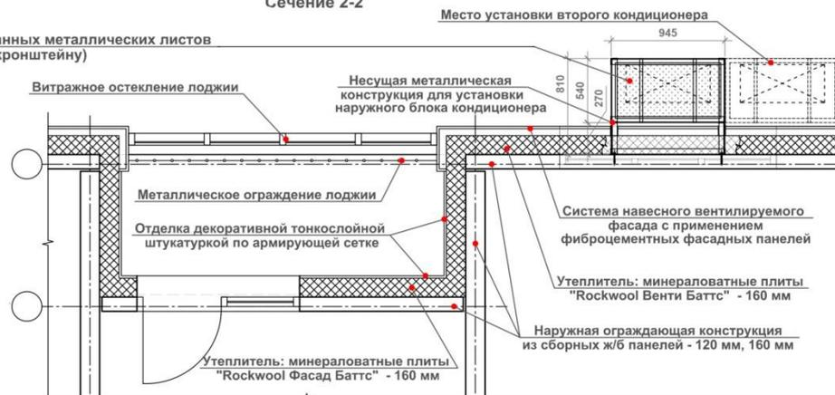
Фрагмент фасада с размещением навесного оборудования, обозначением фасадных конструкций и применяемых отделочных материалов (схема установки кондиционера) (на основе М 1:20)
